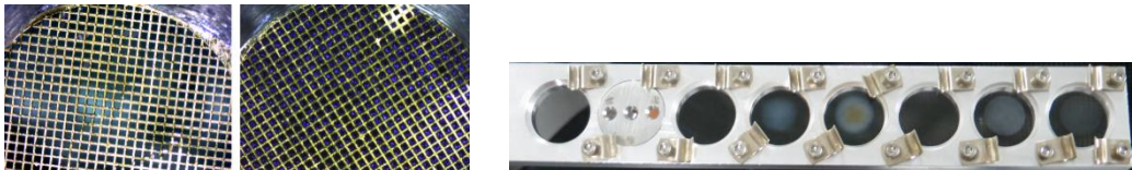
Fig.1 : Membrane de grilles TEM avant et après un dépôt (a-C: H fabriqué avec un précurseur de gaz CH4) sur la membrane. Le porte-échantillon avant l'insertion dans la chambre DISCO / APEX .
